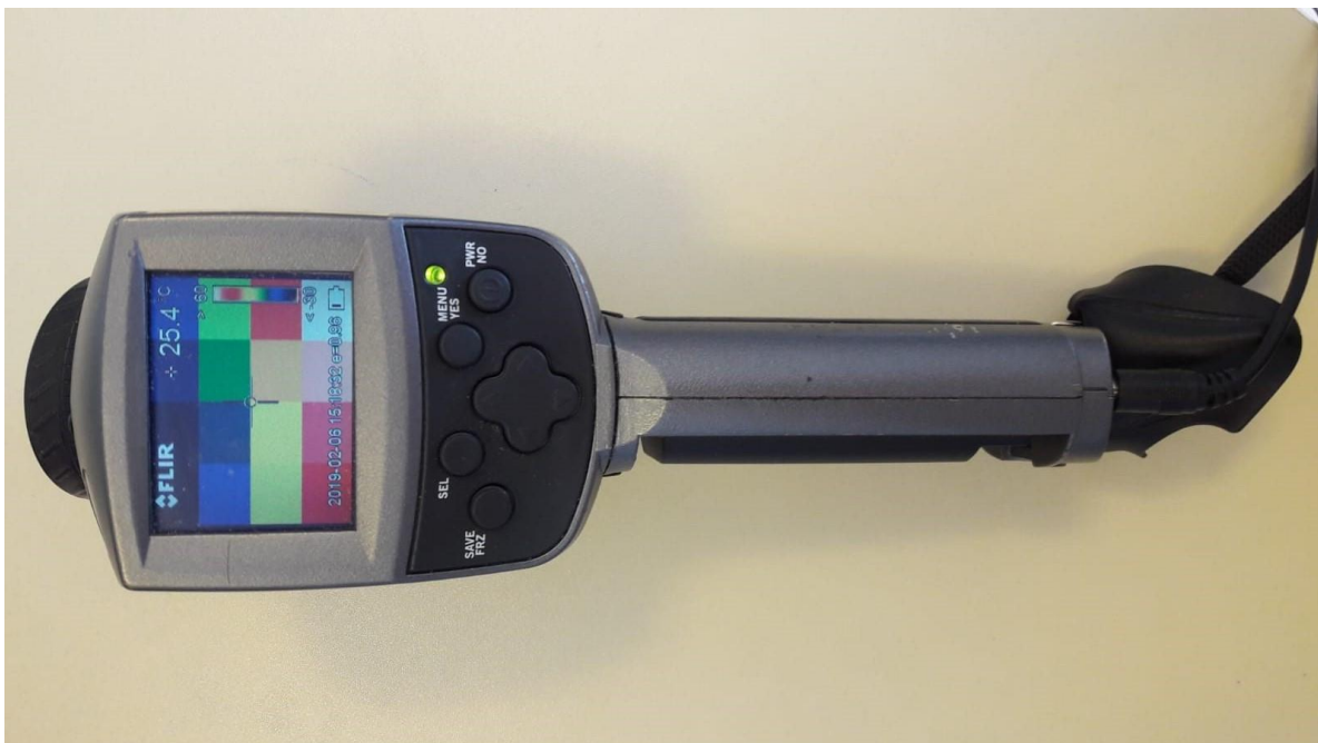
Slika 11. IC termografska kamera Flir Thermacam B2 (Flir System Inc, Oregon, SAD) s kojom je izvršeno istraživanje.
